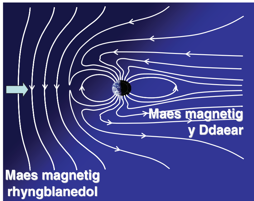
Ffigwr 1: Rhyngweithio rhwng y maes magnetig rhyngblanedol a maes magnetig y Ddaear pan fo'r maes rhyngblanedol wedi ei gyfeirio tua'r de. Mae'r Haul i'r chwith o'r ffigwr, a gwynt yr Haul yn teithio i gyfeiriad y saeth las. Caiff maes magnetig y Ddaear ei agor ger plân y cyhydedd ac yna ei dynnu gan wynt yr Haul o ochr y dydd i ochr y nos.
