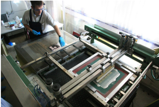
Ffigwr 2: Creu'r lampau drwy ddefnyddio peiriant printio sgriniau. Dangosir y dull o wneudlampau ar ITO. Ar bapur mae'r drefn yn wahanol, gyda haen ychwanegol o PEDOT:PSS ar ben y ffosffor.
